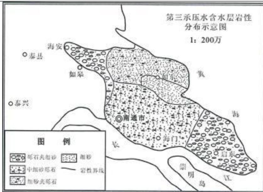
图7-5 第三承压水含水层岩性分布示意图
