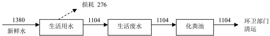
图 2-10 原厂区项目水平衡图（单位：t/a）
