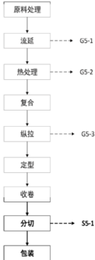
图 2-7 锂电池隔膜（干法）工艺流程图
