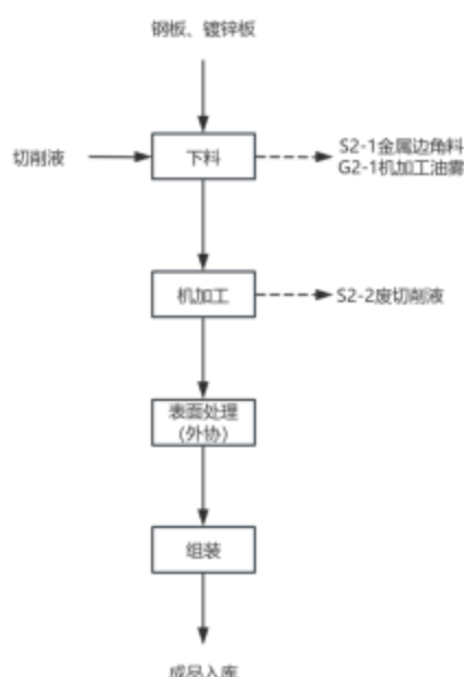
图 2-10 现有项目工艺流程及产污环节图
