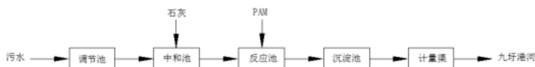
图 4-5 海一厂区废水处理工艺流程图
