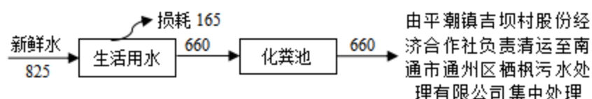
图2-6 水平衡图 (t/a)
