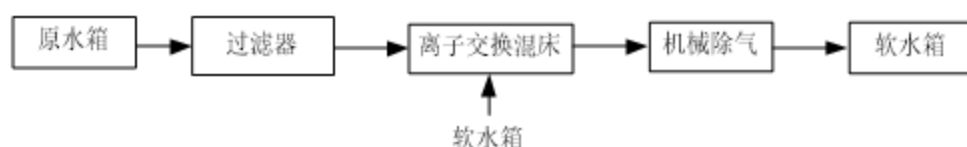
图 4-3 软化除盐工艺流程图
