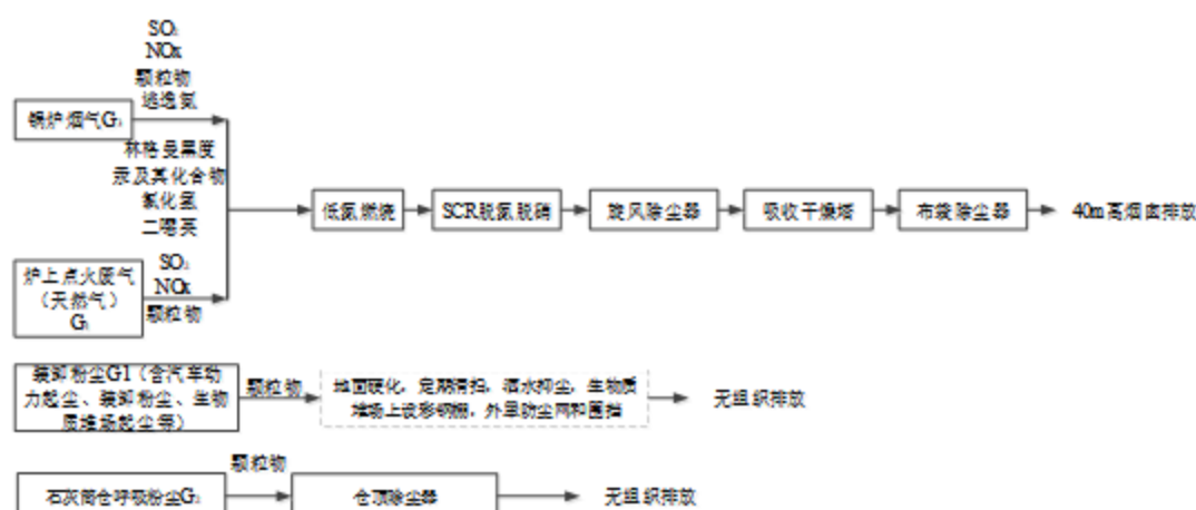
图 4-1 本项目废气处理工艺流程图
